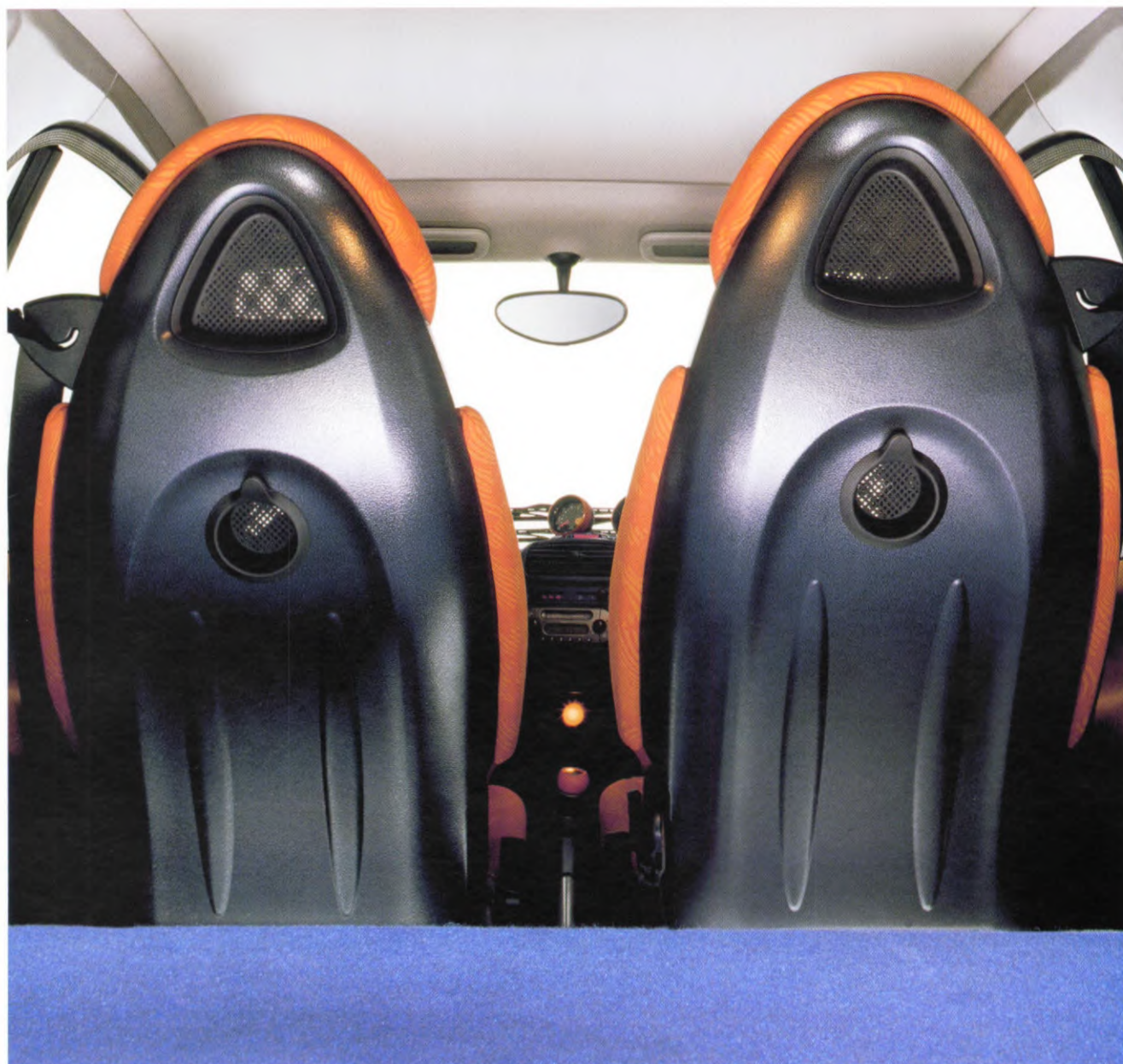
Betrouwbare rugdekking: integrale veiligheidsstoelen met kuip van vormvast staal en geïntegreerde hoofdsteun.
