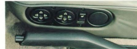
Querstabilisierung und Dämpfung des Fahrwerks eine sorgfältig abgestimmte Funktionseinheit. Die Einstellarbeit übernehmen Elektromotoren. Der Abstand zu Lenkrad und Pedalerie, die Sitzhöhe (vorne und hinten getrennt um jeweils ca. 40 mm verstellbar), die Neigung der Sitzfläche und der Rückenlehne – alles das wird einfach per Tastendruck eingestellt. Beide Vordersitze sind mit Leder bezogen. Auf Wunsch gibt es auch eine Lederausstattung für den gesamten Innenraum.
