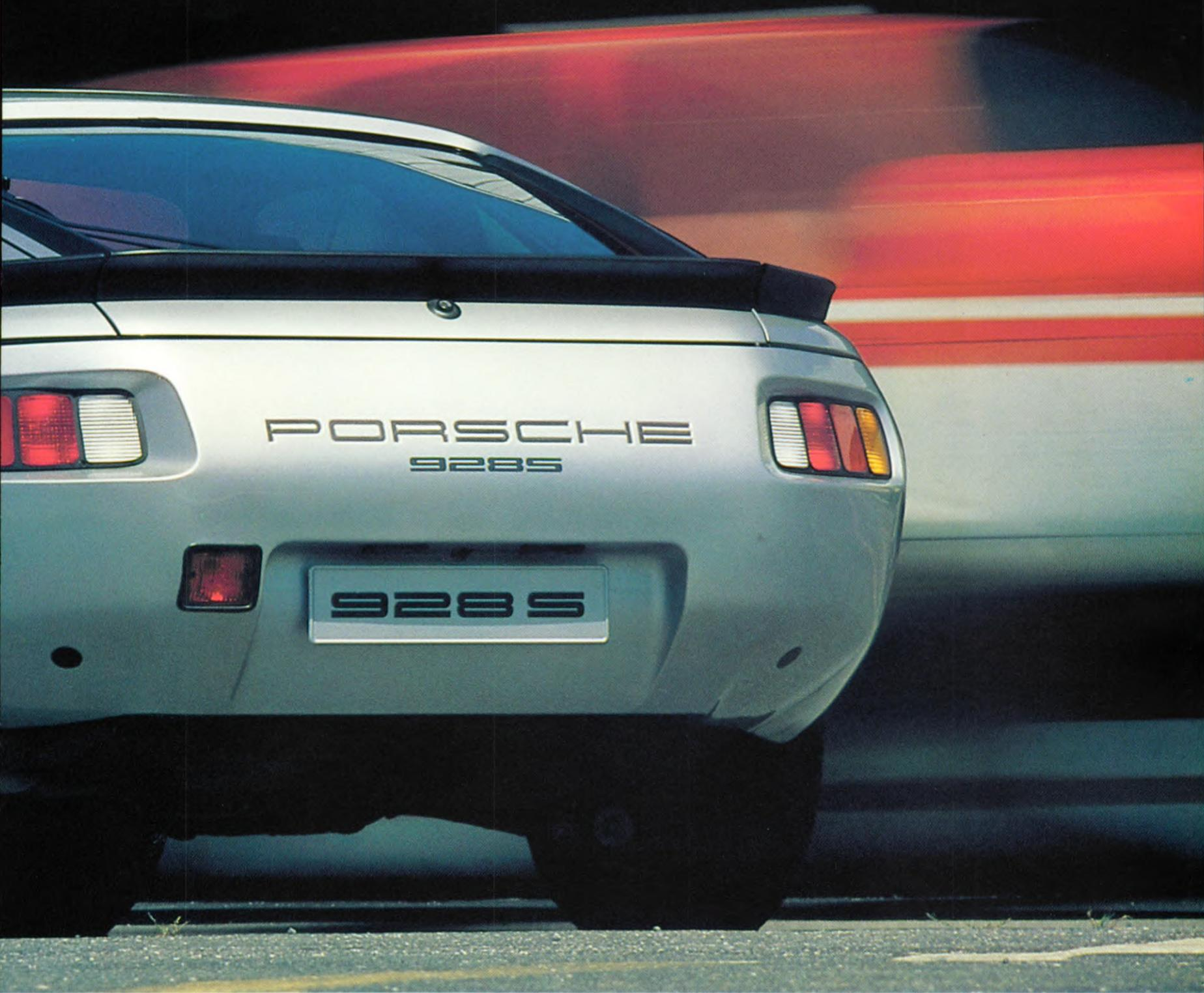
Die Karosserie des Porsche 928 S wurde bereits im sogenannten Grundkörper so ausgelegt, daß die Auftriebskräfte selbst bei hohen Geschwindigkeiten die Kursstabilität des Wagens nicht beeinträchtigen können. Durch große seitliche Flächen im Heckbereich wird der Seitenwindangriffspunkt zum Schwerpunkt hin verlagert. So wird die »Hebelwirkung« des Seitenwindes erheblich verringert. Darüber hinaus
