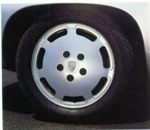
Der Porsche 928 S wird serienmäßig mit Hochgeschwindigkeitsreifen der Größe 225/50 VR 16 (schlauchlos) geliefert, die auf geschmiedete silbereloxierte Aluminiumräder 7 J x 16 montiert sind. Als Winterreifen
