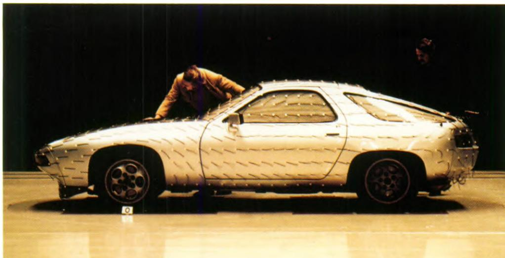
Im Windkanal sind nicht nur Luftwiderstandswerte zu ermitteln, sondern auch die spezifischen Strömungsverläufe an einer Karosserie. Und: die durch den Fahrtwind auf der Fahrzeugoberfläche entstehenden unterschiedlichen Luftdruckzonen. Dadurch konnten sowohl die ideale Anordnung als auch die Größen der verschiedenen Luftöffnungen für die Motorraum-Kühlung und für die Be- und Entlüftung des Innenraums des Porsche 928 S exakt ermittelt werden.
