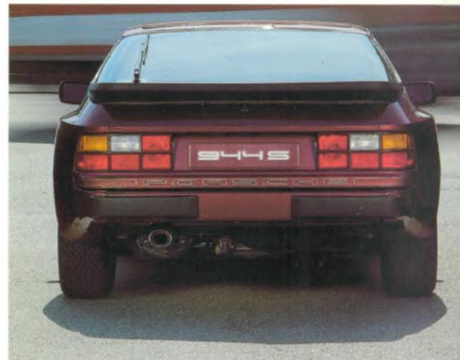
Beim Porsche 944 Turbo erfüllt eine speziell für dieses Hochleistungsfahrzeug entwickelte Flügel-Schürze (unter der Heckstoßstange) gleich drei Aufgaben: Die Luftführung der Unterbodenströmung wird verbessert, das Seitenwindverhalten stabilisiert und gleichzeitig werden der hintere Tankraum, das Getriebe und der Endschalldämpfer wirkungsvoll gekühlt.
