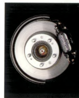
Die vorderen Scheibenbremsen von 911 Carrera 2 und 4
