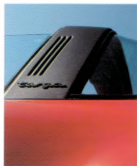
Der Targa Bügel hat die Funktion eines Überrollbügels
