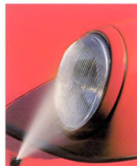
Hochdruckpumpen reinigen die H4-Scheinwerfer von Carrera 2 und 4
