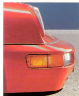
Stoßfänger aus Bexloy schützen gegen Stein Schlag
