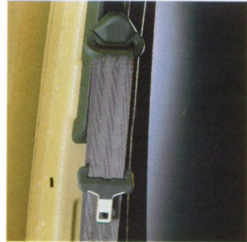
In hoogte verstelbare veiligheidsgordels met pyrotechnische spanners voor twee zitplaatsen vóór
