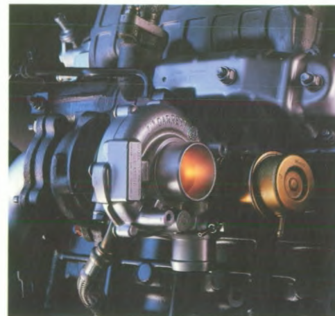
1.9-LITERTURBODIESEL De eerste turbodieselmotor in ons programma is een door en door beproefd ontwerp van de Volkswagen Groep, dat kracht aan prestatievermogen koppelt en bovendien superzuinig is.
