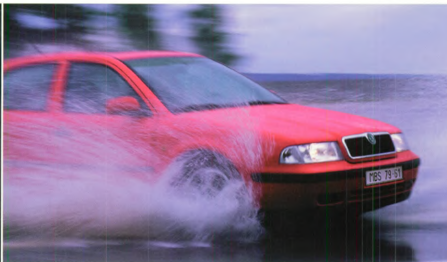
ABS zorgt ervoor dat de remmen niet kunnen blokkeren. In de praktijk betekent dit dat de auto perfect reageert op uw stuurinstructies, hoe hard u ook remt. Als toevoeging op uw ABS kunt u ook kiezen voor EDS, dat zorgt voor een optimale tractie op gladde wegen. Voor de dieselmotoren is er MSR beschikbaar, een motorgestuurd antislipsysteem.
