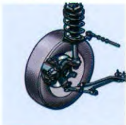
De voortrein van het type pseudo McPherson: dé garantie voor een precieze geleiding, met name in bochten.
