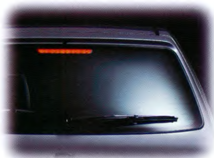
Het derde remlicht is in het bovenste deel van de achterklep geplaatst, zodat het vanaf grote afstand en voor iedereen duidelijk zichtbaar z'n attentieverhogende werking kan doen.
