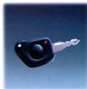
Contactsleutel met geïntegreerde startblokkering en centrale vergrendeling met afstandsbediening.
