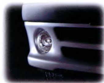
In de voorspoiler geïntegreerde ronde verstralers.
