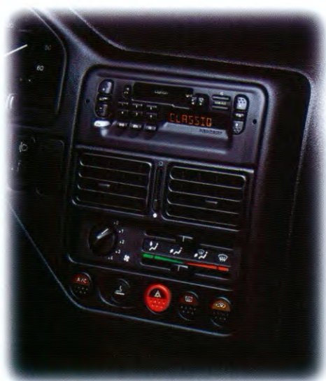
De middenconsole met o.a. het bedieningspaneel van de verwarming en ventilatie en diverse functietoetsen. De radio en airconditioning* zijn optioneel.
