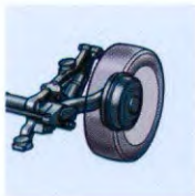
De achtertrein met getrokken wiel-draagarmen en torsiestaven: voor een ideaal evenwicht tussen wegligging en groots comfort.
