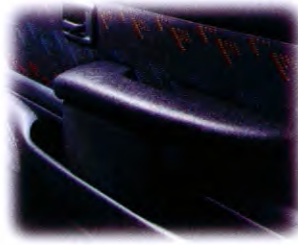
In combinatie met de portieversterkingen minimaliseren de kunststof paddings de gevolgen van een zijdelingse aanrijding.
