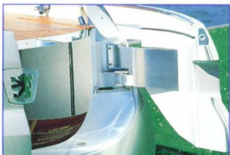
Die Gestaltung dieser Fläche ist im Stile von Schiffsaufbauten gehalten; die Hecktür besitzt einen originellen Öffnungsmechanismus, über den jeder der beiden Türflügel unabhängig vom anderen geöffnet werden kann.
