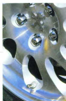
Detectie van een te lage bandenspanning.
