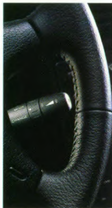
Autoradio met afstandbediening via een handel onder het stuurwiel.
