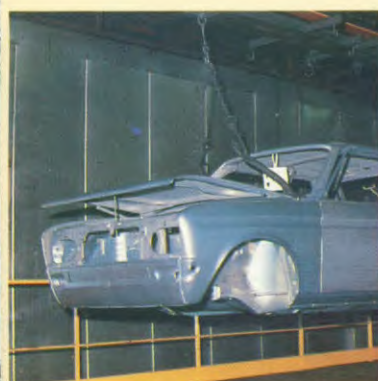
2 BEHANDELING MET IJZERFOSFAAT: Beschermst tegen stoten en bladderen, verhoogt de hechting tijdens de cataforese. De holle delen zijn ontvet en gefosfateerd vóór de assemblage.
