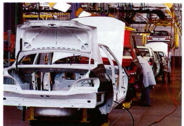
Minutieuze controle van de carrosserie. Dit gebeurt op vaste plaatsen van de assemblagelij
