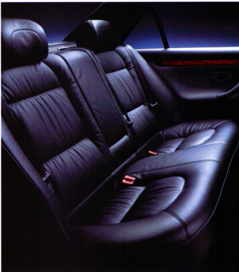
Interieur met lederen bekleding tegen meerprijs op de 406 SV-versies. De zij-delen van de achterbank zijn vast met de structuur verbonden, waardoor het neerklappen van de rugleuningen wordt vergemakkelijkt en ze de armleuningen van de achterportieren niet raken.
