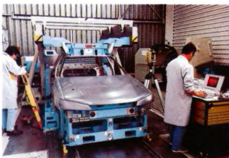
Controle van alle plaatwerkdelen, waarbij torsiestijfheidsmetingen worden uitgevoerd.
