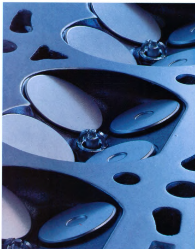
Cilinderkop met vier kleppen per cilinder. Elke klep wordt geactiveerd door een hydraulische klepstoter met automatische afstelling van de speling. Door een systeem van een anti-terugslagklep blijft de oliedruk in de stoter bij afgezette motor constant, waardoor deze minder geluid produceert bij het weer starten.
