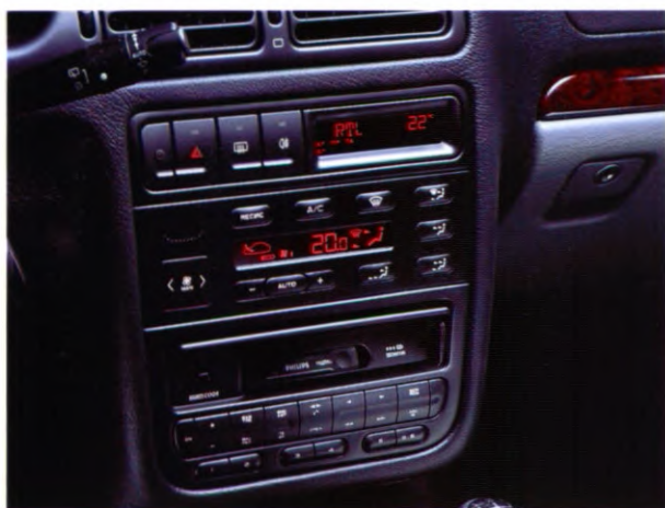
Middenconsole met hier afgebeeld een tegen meerprijs af dealer verkrijgbare radio/CD (4 x 20W met 4 speakers en 2 tweeters) voorzien van een anti-diefstalcode en bedieningshendel aan het stuur. Tevens de op de SV tegen meerprijs verkrijgbare climat control met digitaal bedieningspaneel.
