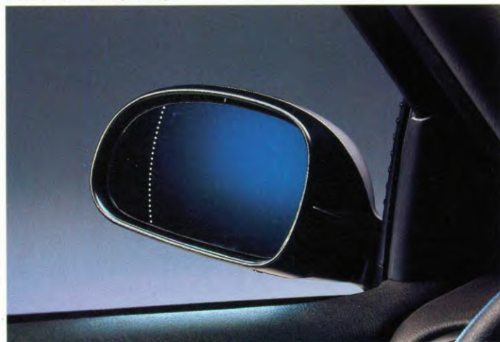
Buitenspiegel bestuurderszijde met geminimaliseerde dode boek.
