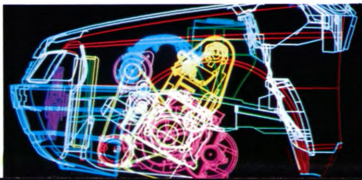
Door de computer berekende plaatsing van de motor (dwars-aanzicht).
