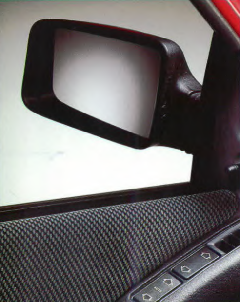
Van binnenuit verstelbare buiten- spiegel met verwarming. Elektrische voorrui bediening is extra tegen meerprijs
