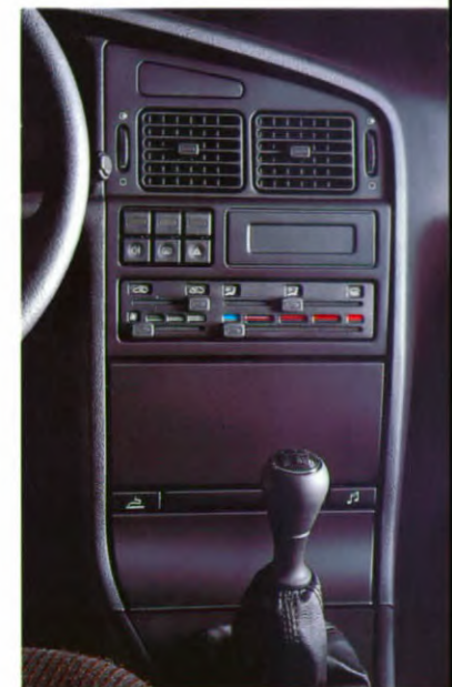
Deel van het dashboard met de bedieningshandels van de verwarming/ventilatie
