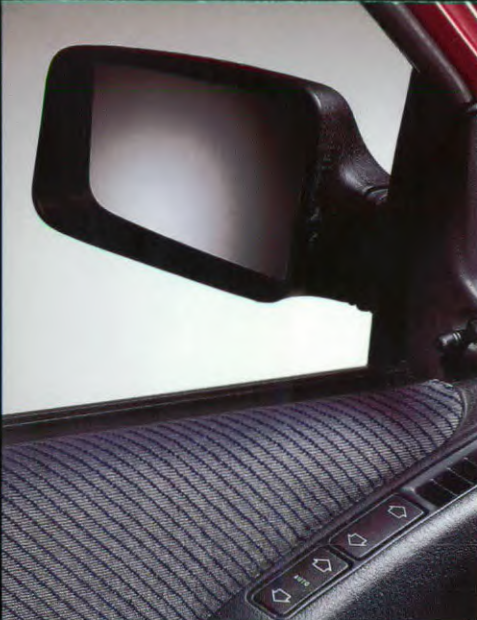
Van binnenuit verstelbare buiten- spiegel met verwarming en de in de armsteun geïntegreerde tiptoetsen voor de elektrisch bedienbare voorportierraaien
