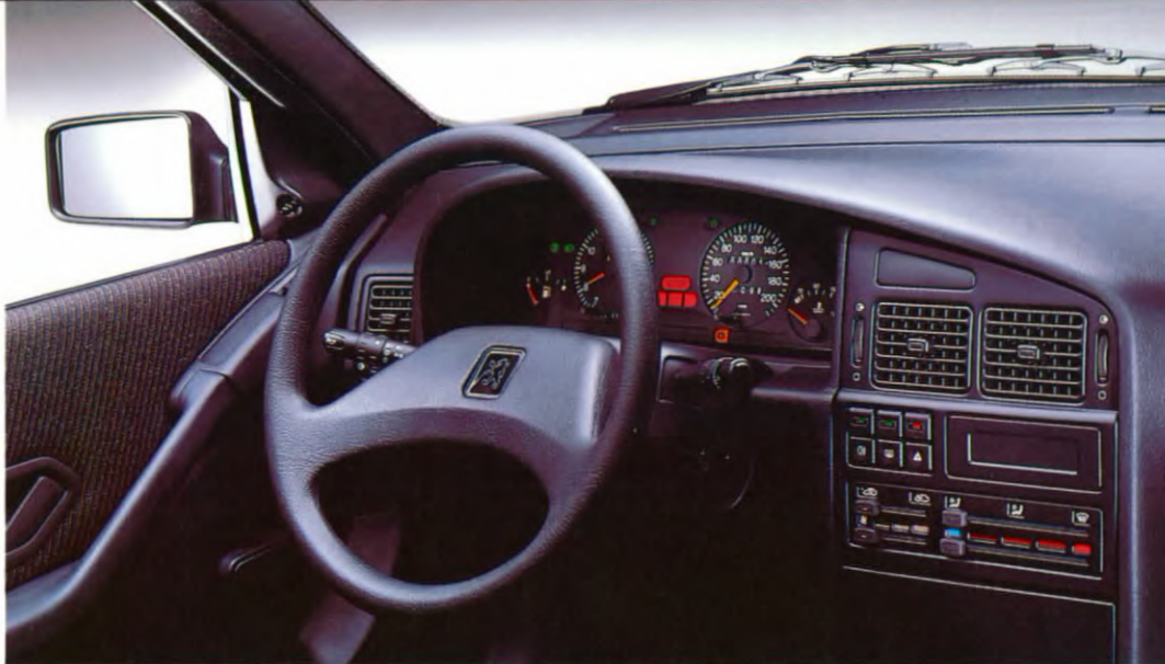
Bestuurdersplaats met het in de hoogte verstelbare stuurwiel
