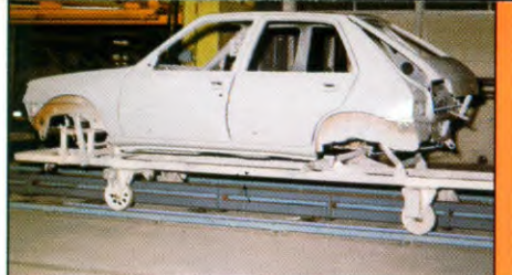
6 – DE GRONDLAAG. Een soepele speciale grondlaag verleent de lak een hoge weerstand tegen steenslag.
