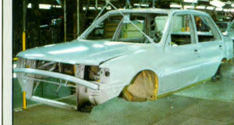
1 – VOORBEHANDELD PLAATSTAAL: Het elektrisch verzinkte en het gegalvaniseerde plaatstaal omvat meer dan 50 gewichtsprocenten van de structuur van de 309. De verbindingsnaden van de structuur zijn eveneens afdoende beschermd tegen corrosie. Bovendien zijn bijna alle naden van de onderzijde voorzien van een doorlasbare zinkprimer. De assemblage van de bewegende delen geschiedt door middel van lijmen en felsen.
