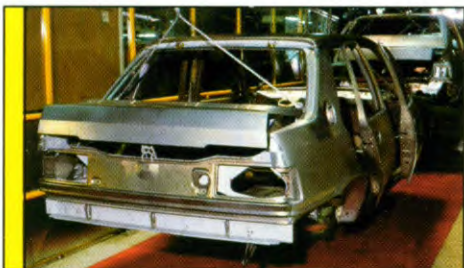
2 – DE FOSFATERING. De carrosserie wordt ontvet en gefosfateerd om de hechting van de harslaag tijdens het cataforësebad te bevorderen.
