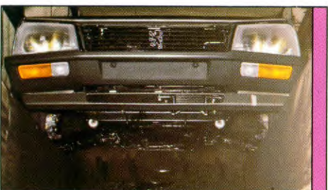
10 – DE DIKKE WAS. Wordt aangebracht aan de onderzijde. Het wasbitumenmengsel en de pigmenten met corrosieremmende eigenschappen verhinderen het binnendringen van water en vocht in de holle ruimten.
