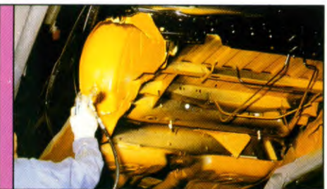
5 – DE ANTI-STEENSLAGLAAG. De onderste zijanten van de carrosserie, de wielkuipen en een deel van de bodem worden beschermd door de toepassing van PVC.
