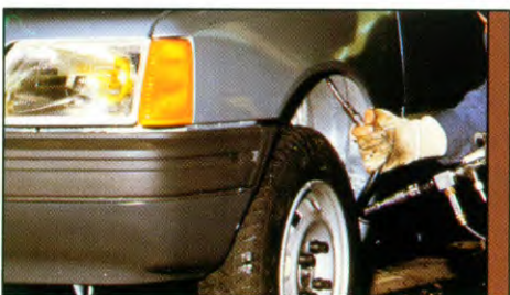
9 – DE WAS. Insputting onder hoge druk in de holle delen (langsliggers, dwarsliggers, binnenruimten van de portieren...) beschermt de binnenvlakken en door tussen de naden te dringen wordt corrosie voorkomen.
