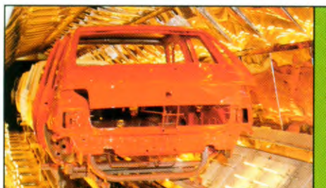
7 – DE ACRYLAATLAK. Een warmhardende speciale lak geeft de carrosserie een zeer hoog glansvermogen.
