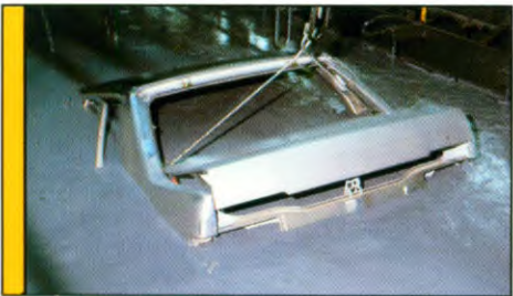
3 – HET CATAFORËSEBAD. Ondergedompeld in een bad met epoxyhars wordt de carrosserie bedekt met een anti-corrosiefilm. De holle ruimten zijn van doorstroomopeningen voorzien, zodat ook de binnenvlakken volledig worden bedekt.
