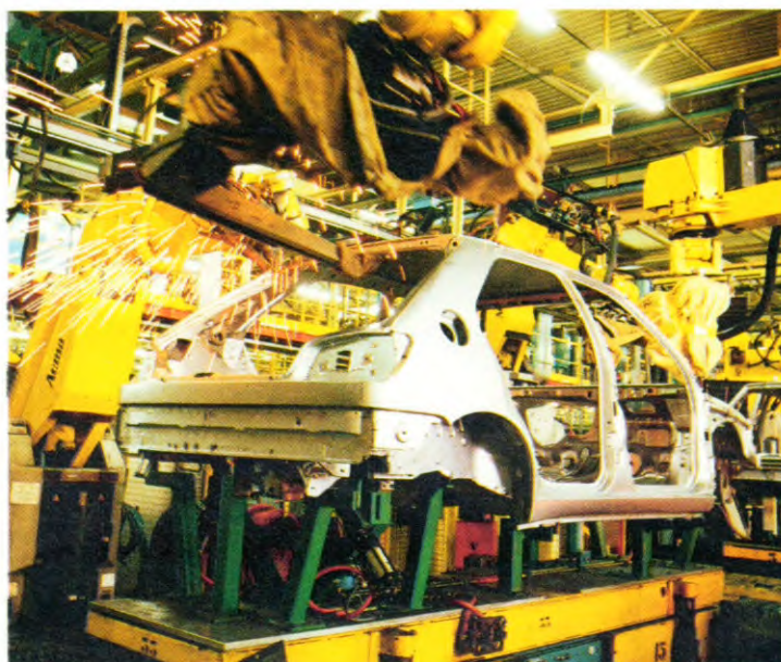
bij elke 306 worden 4.000 puntlassen uitgevoerd door robots.
