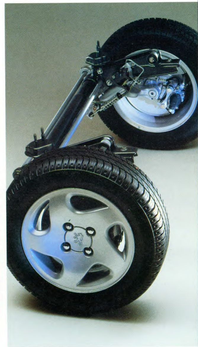
het meesturende karakter van de achtertrein gecombineerd met de stabilisatorstang: een stukje toptechniek.
