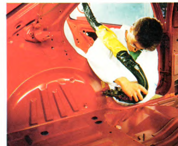
door de holle delen met schuim te injecteren worden zowel de anti-corrosie als de geluidsisolatie positief beïnvloed.
