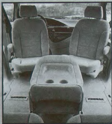
Op eenvoudige manier kunnen de zetels van de Peugeot worden gedraaid of omgebouwd tot tafeltje.
