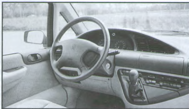
Bij de 806 is de versnellingspook in het dashboard opgenomen. Het stuurwiel kan in hoogte worden versteld en heeft een airbag.
