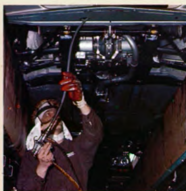
9 UNDERCOATING OP BITUMEN BASIS: Voorkomt binnendringen van water en vocht in holle delen.
