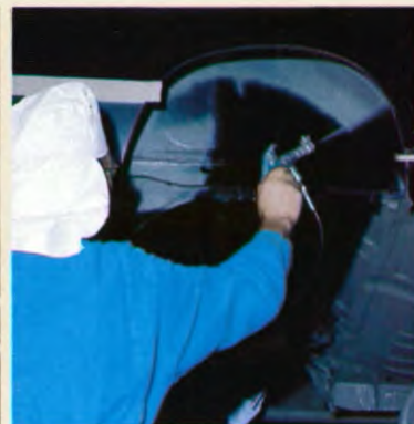
5 OVENGEGEHARDE PVC COATING: van 1 à 2 mm dik. Beveiligt carrosseriedelen die aan steenslag e.d. worden blootgesteld.
