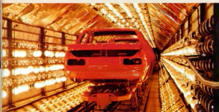
8 VERNISLAK: (Alleen bij Peugeot's met metaallak of noir). Verhoogt de glans en heeft een extra beschermende functie voor kleerpigmentatie en tegen verwerking.
