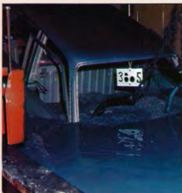
3 CATAFORESEBAD: Aanbrengen van een grondlaag op de carrosserie. De holle ruimten zijn van doorstroomopeningen voorzien, zodat ook de binnenkant wordt bereikt.
