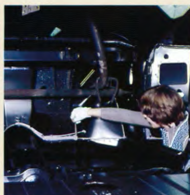
4 WASBEHANDELING: Door drukinspuiting in holle delen. Beschermst binnenwanden en voorkomt dat water tussen de plaatverbindingen dringt.
