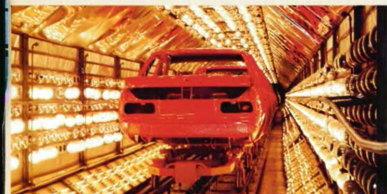
8 VERNISLAK: (Alleen bij Peugeot's met metaallak of noir). Verhoogt de glans en heeft een extra beschermende functie voor kleurpigmentatie en tegen verwerking.
