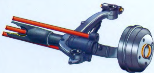
Achterrein met getrokken wieldraagarmen, torsiestaven en stabilisatorstang.
