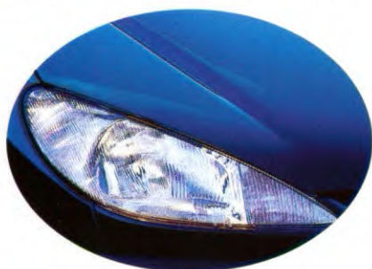
Uit één stuk bestaande koplamp-units van vrijwel onbreekbaar polycarbonaat.
