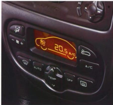
Automatisch geregelte Klimaanlage mit Digitalanzeige
