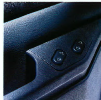
Elektrisch bedienbare voorportier-ruiten tegen meerprijs leverbaar in combinatie met centrale vergrendeling met afstandsbediening
