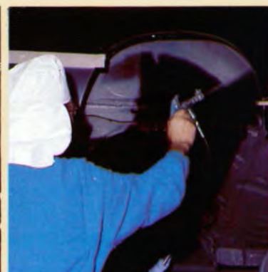
5 OVENGEGARDE PVC COATING: van 1 à 2 mm dik. Beveiligt carrosseriedelen die aan steenslag e.d. worden blootgesteld.
