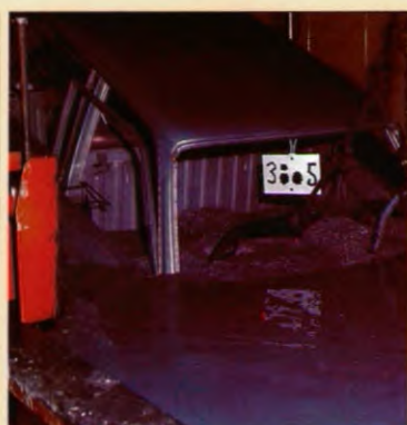
3 CATAFORESEBAD: Aanbrengen van een grondlaag op Aanbrengen van een grondlaag op De holle ruimten zijn van doorstroomopeningen voorzien, zodat ook de binnenkant wordt bereikt.
