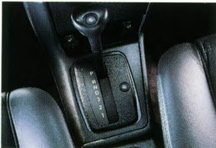
De moderne 4-traps automaat is elektronisch gestuurd en kent drie instelbare rijprogramma's.
