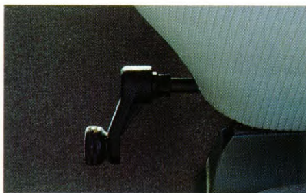
In hoogte verstelbare bestuurdersstoel (vanaf GLS).
