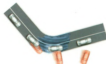
De nieuwe onafhankelijke "multi link"-achterwielophanging van de Vectra staat borg voor meer controle en een rustiger weggedrag.
