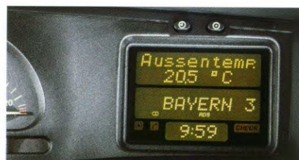
Het “multi function”-display geeft nauwgezet de digitale informatie van de boardcomputer en het check-control-systeem door.
