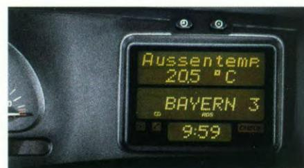
Das Multi Info Display: präzise, digitale Informationen über Uhrzeit, Radiofunktionen, Meldungen des Bordcomputers und des Opel Check Control-Systems.
