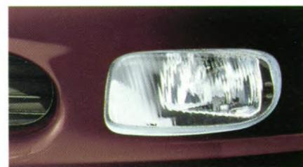
*Gelungene Verbindung von Sicherheit und Design: Die Nebelscheinwerfer im Vectra Caravan CD sind in die Stoßfänger integriert.*
