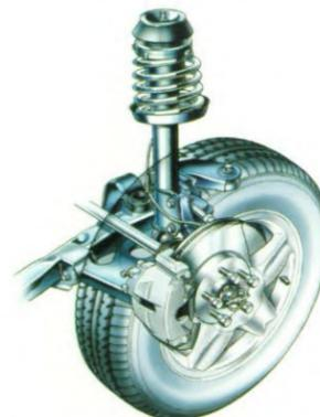
Die Vorderräder des Vectra werden über Gasdruckfederbeine mit Querlenker und Stabilisator geführt und sind individuell auf das jeweilige Modell abgestimmt.
