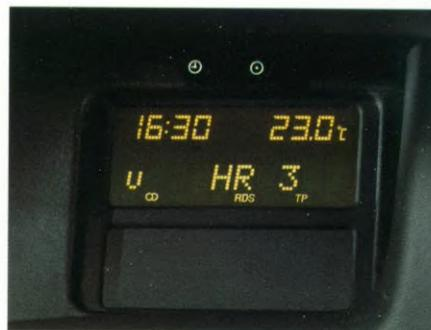
Das Triple Info Display liefert digitale Informationen über Uhrzeit, Außentemperatur, Radiosenderanzeige bzw. Datum. Serienmäßig in Verbindung mit Radio-Cassettengerät.
