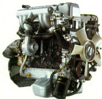
2.3 Turbo-diesel. 63 kW (86 DIN-pk) bij 4200 min -1 . Max. koppel 189 Nm bij 2200 min -1 . KKK-turbo-lader, elektronisch voorgloeisysteem.
