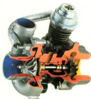
In de turbo-lader drijven uitlaatgassen een turbine aan. Die is verbonden met de kompressor, die extra lucht in de cilinders perst. Daardoor stijgen rendement en vermogen.
