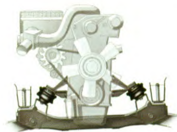
De onderhoudsvrije hydraulische motorsteunen dempen trillingen en geruis.
