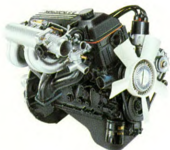
2.2 i-motor. 85 kW (115 DIN-pk) bij 4800 min -1 . LE-Jetronic met brandstoftoevoerregeling, stationair-regeling, elektronische ontsteking.
