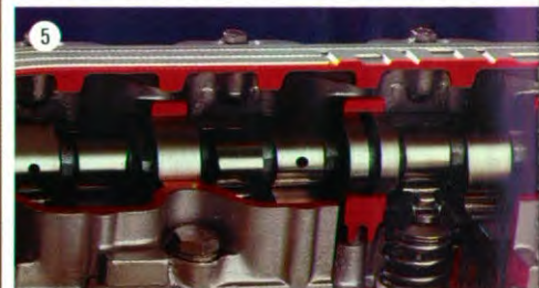
① McPherson-veerpoten. ② Miniblokveren. ③ Voorwielophanging. ④ Service-opening voor koppeling en aandrijving. ⑤ Bovenliggende nokkenas.
