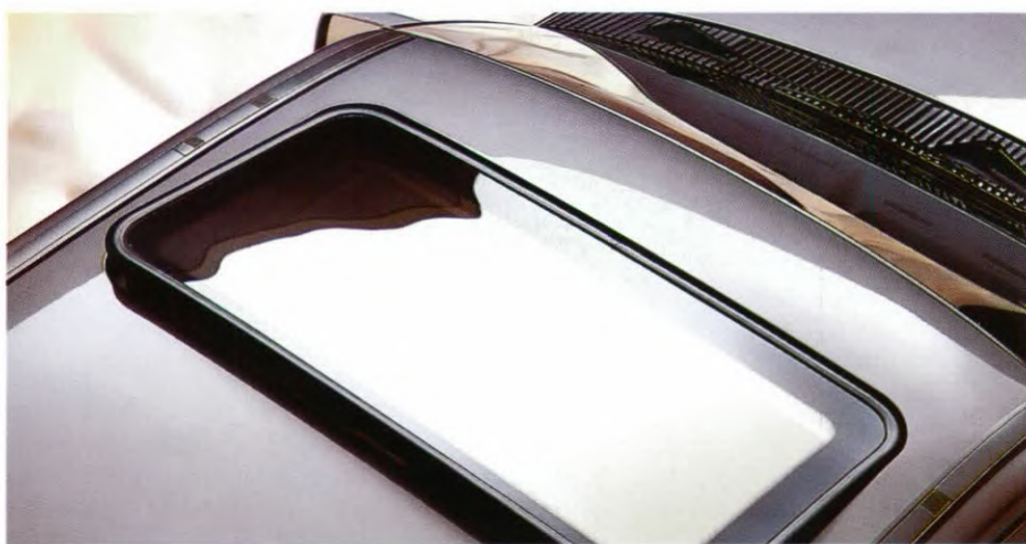
Schuif-/kanteldak van getint glas met wegschuifbare zonneluifel.
