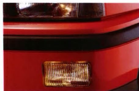
Geïntegreerde mistlampen in voorspoilers.
