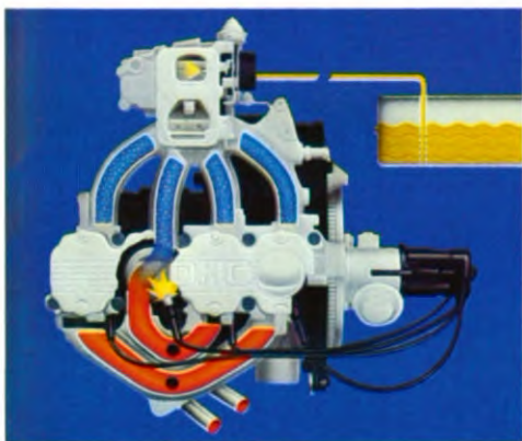
Lichtmetalen cilinderkop met dwars stroomventilatie.
