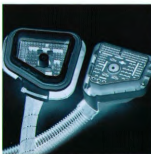
De nieuwe cockpit-connector met max. 100 pennen draagt bij tot grotere betrouwbaarheid en een betere akoestische afscherming van de passagiersruimte.
