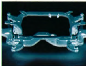
Het subframe met 6 ontkoppelingspunten voor nog meer rijcomfort en betere stureigenschappen.
