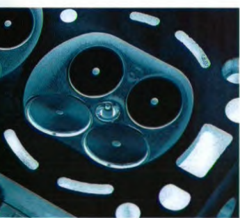
De 4-kleppentechniek van Opel, met centraal geplaatste bougies, is karakteristiek voor de krachtige, economische en schone ECOTEC-motoren.
