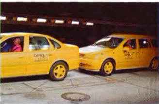
A: 40 402 - 277 180°, car to car, 70 km/h 180°, Fahrzeug-Fahrzeug, 70 km/h
