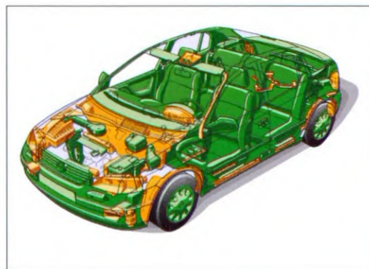
A: 40 467 - 300 Green: recyclable parts Orange: recycled parts Grün: Recyclbare Teile Orange: Recycelte Teile
