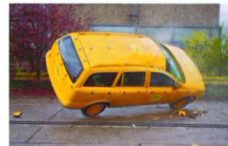
A: 40 414 - 282 Roll-over, 50 km/h Überschlag, 50 km/h
