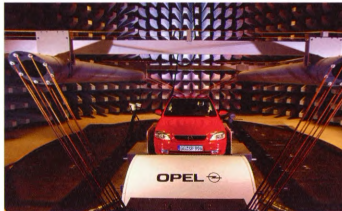
A: 40 459 - 298 Testing electronic systems Bewährungsprobe für elektronische Systeme
