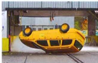
A: 40 416 - 281 Roll-over, 50 km/h Überschlag, 50 km/h
