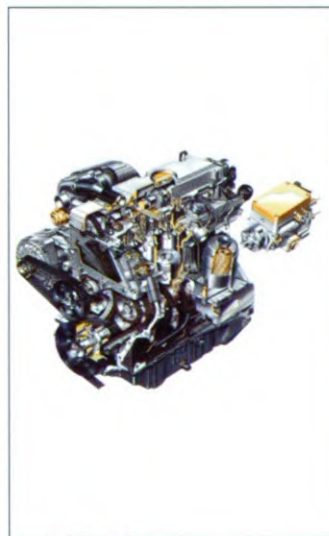
A: 22 844 - 117 ECOTEC 2.0 DI 16V with Bosch VP44 injection pump (top right) ECOTEC 2.0 DI 16V mit Bosch VP44 Einspritzpumpe (oben rechts)
