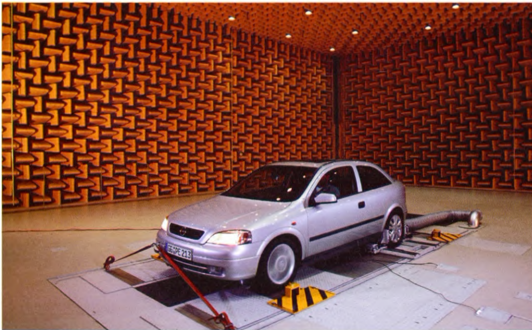
A: 40 448 - 297 Test drive on the rolling-road Testfahrt auf dem Rollenprüfstand
