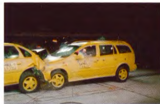
A: 40 417 - 279 180°, car to car, 70 km/h 180°, Fahrzeug-Fahrzeug, 70 km/h
