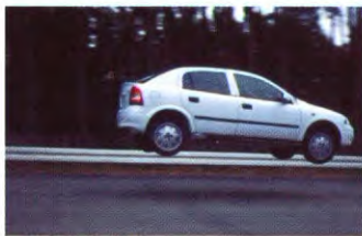
A: 40 445 - 284 Airbag misuse test: airbag must not deploy Airbag Misuse Test (Airbag darf nicht auslösen)
