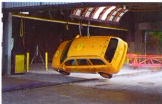
A: 40 413 - 280 Roll-over, 50 km/h Überschlag, 50 km/h
