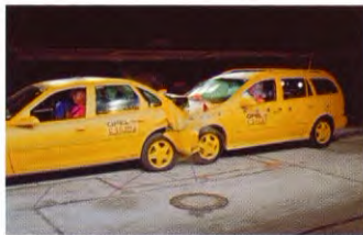
A: 40 403 - 278 180°, car to car, 70 km/h 180°, Fahrzeug-Fahrzeug, 70 km/h
