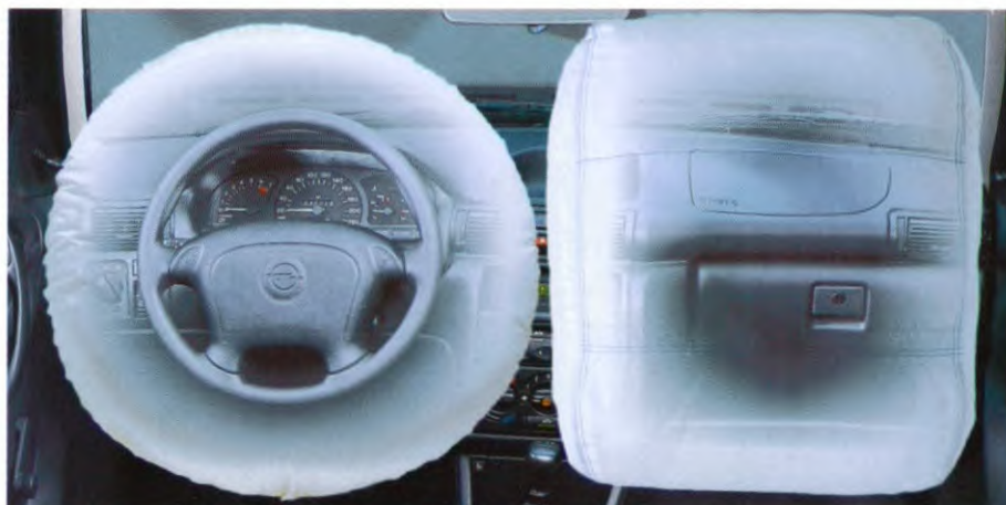
Opel Full-Size Airbags. Tot 30% groter dan bijvoorbeeld de Eurobags – en dat verschil zorgt met name voor meer bescherming bij zijwaartse aanrijdingen.
