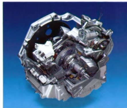
De nieuwe, elektronisch gestuurde 4-traps automatische versnellingsbak van de Astra is uiterst kompakt en zorgt voor zuinig energieverbruik en soepel rijgedrag.
