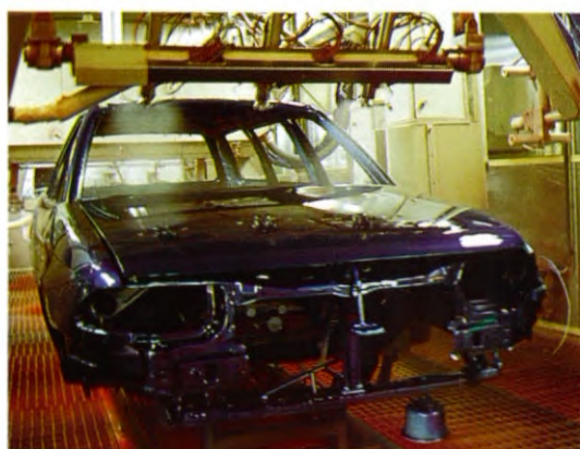
In deze milieuvriendelijke lakstraat in de Opel-fabriek wordt nog slechts een fractie aan organische oplosmiddelen gebruikt.
