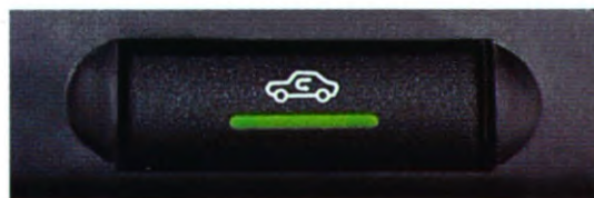
Met één druk op de knop schakelt het gehele verwarmings- en ventilatiesysteem over op gerecirculeerde interieurlucht.
