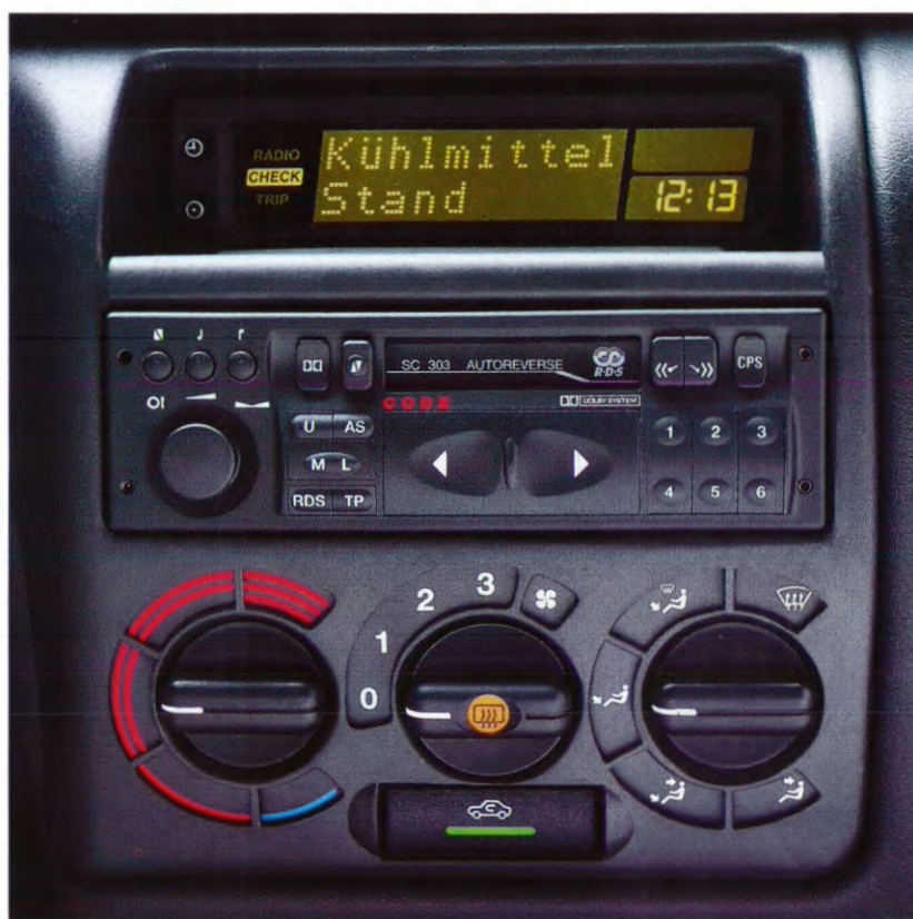
Het "multi function"-display met de speciale Astra-radio (optie) in Astra CD en Astra GSi. Met één druk op de knop krijgt u alle vitale functies van het Opel-Checkcontrol-Systeem, de boardcomputer, tijd en radiofrequentie via het display op een presenteerblaadje.
