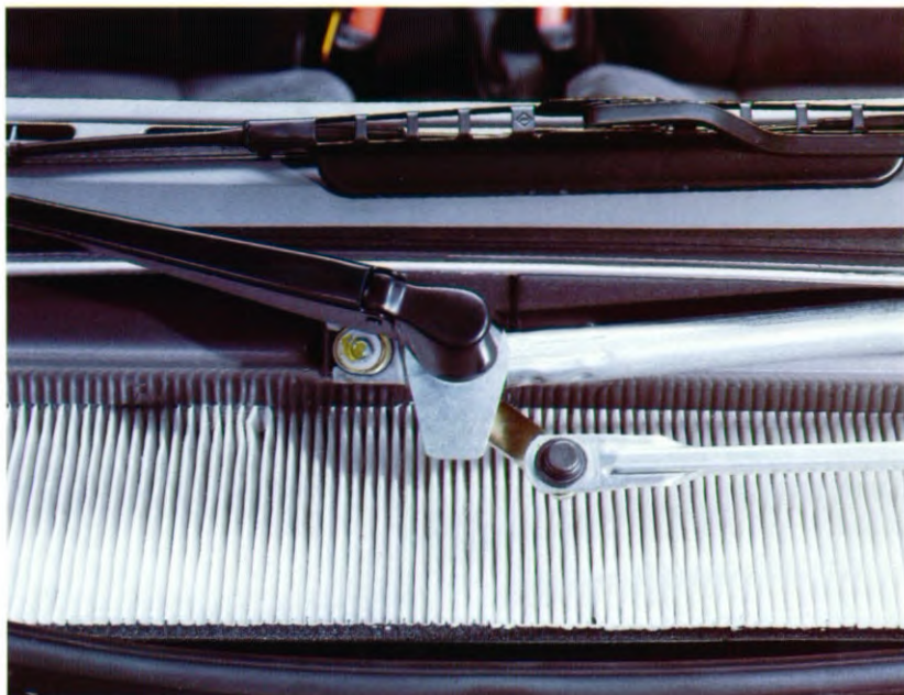
Standaard in elke Astra: het unieke interieur-luchtrecirculatiesysteem met microfilters, waarmee een trefzekere bescherming tegen stuifmeel, roet en andere kleine stof- en vuildeeltjes wordt gegeven.
