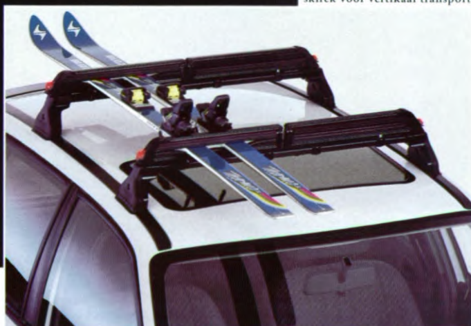
Skirek voor horizontaal transport van zes paar ski's, afsluitbaar. Er is ook een skirek voor vertikaal transport.
