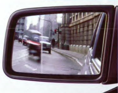
Voor een veilig overzicht over al het verkeer zorgt de groot-hoek-overzetspiegel . (Montage over de buitenspiegel.)
