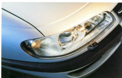
Helderder licht voor de Omega, beter zicht voor de bestuurder: Xenon-koplampen met dynamische niveauregeling en reinigingsinstallatie (standaard op Sport, CDX en MV6).
