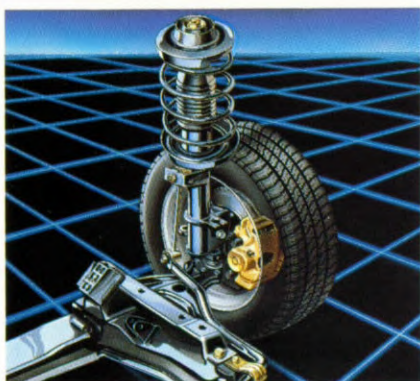
Voorwielophanging met negatieve schuurstraal en McPherson-veerpoten.
