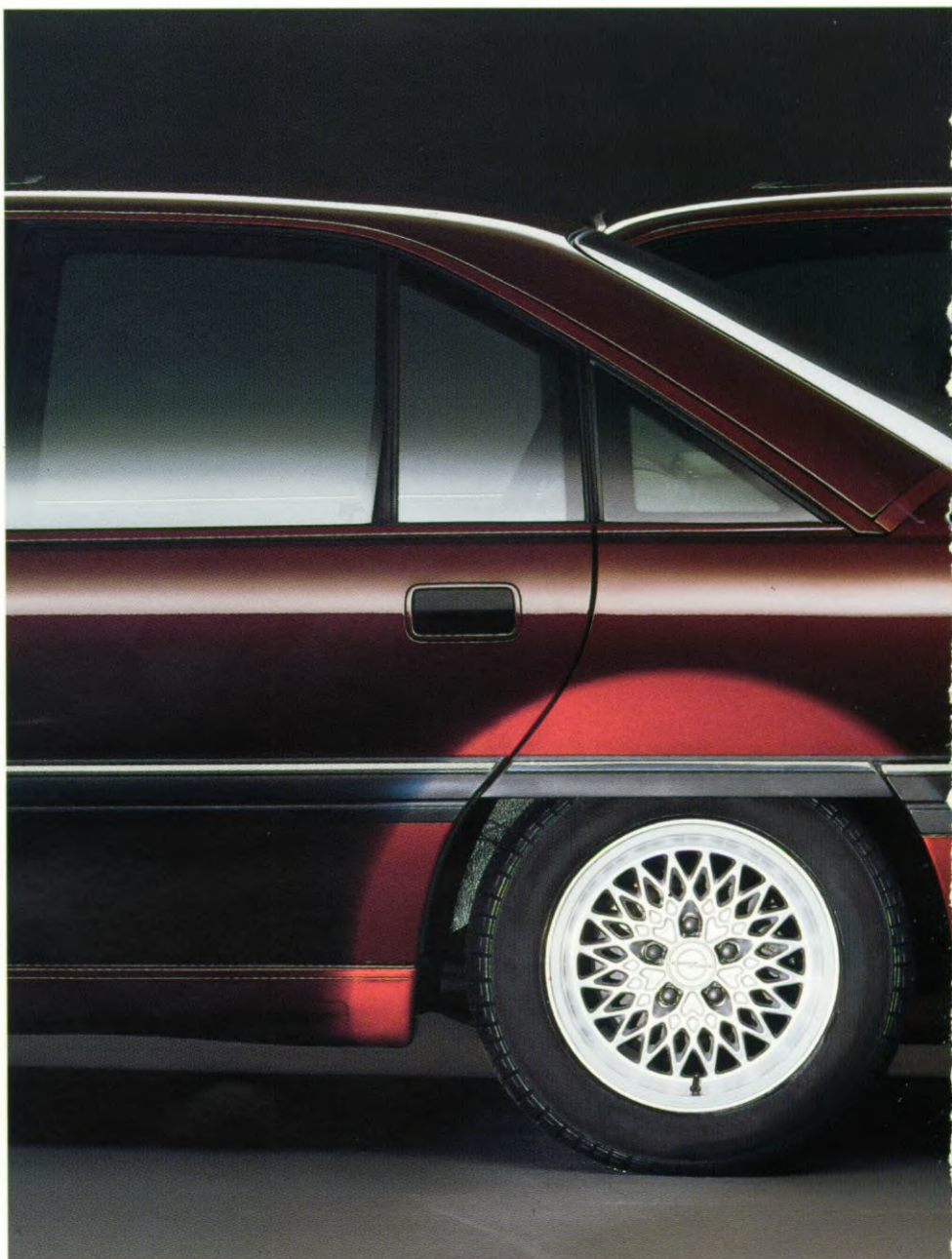
Sportieve aluminium velg met sierdop voor wielnaaf en afdekdoppen voor wielbouten. Zilver. Maat: 7 J x 15 ET 33.
