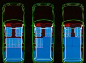
De Omega 3.0 i Stationwagon herbergt een laadruimte van meer dan 2 meter bij 114 centimeter (tussen de wielkasten), en een laadopeningshoogte van 75 centimeter. Bij een neergeklapte achterbank komt dit neer op 1850 liter bruto laadruimte. (VDAmeting.)
