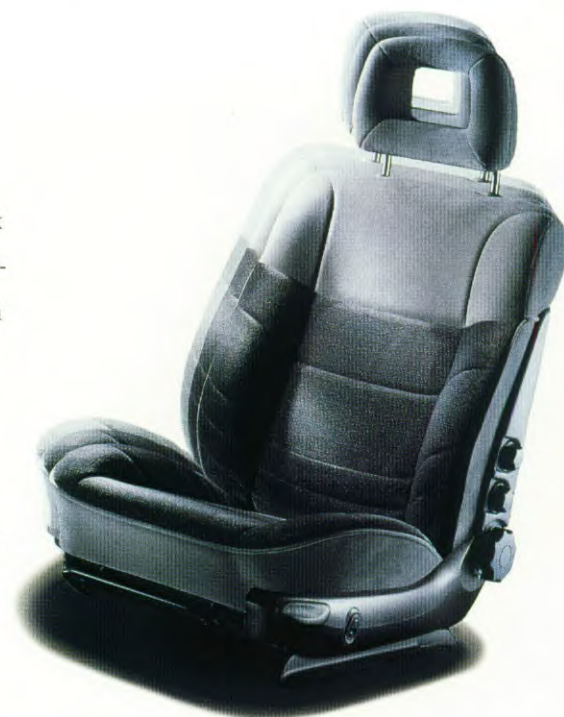
Elektrisch in hoogte verstelbare bestuurdersstoel: met één knop stelt u comfortabel uw individuele zithoogte in.
