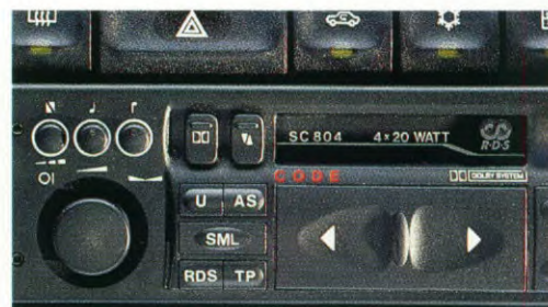
Iedere radio in de nieuwe Omega MV6 is voorzien van een eigen code en een afneembaar bedieningspaneel.
