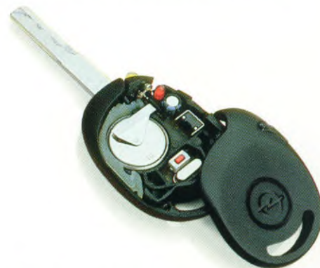
Met de infrarood-knoppen op de sleutel worden zowel de elektronische startonderbreking als alle functies van de centrale deurvergrendeling geactiveerd en de elektrische ramen en eventueel het elektrische schuif-/kanteldak gesloten.
