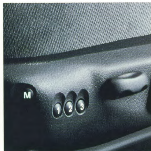
Elektrisch bedienbare, in 8 standen verstelbare voorstoelen.
