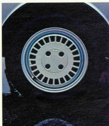
Nieuwe lichtmetalen wielen waarvan één kant volkomen gelijk ligt met de band voor betere aerodynamische eigenschappen. Als standaard op het nieuwe luxe model aanwezig.
