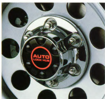
Automatische vrijloopnaven (optie voor Frontera Sport).
