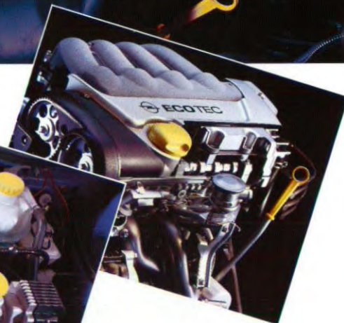
De 1.4i-motor met 44 kW (60 DIN-pk) of de temperament- vollere 1.4i-16V- krachtbron met 66 kW (90 DIN-pk).
