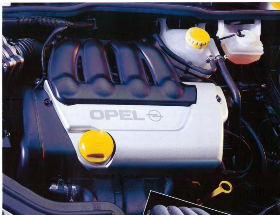
De 1.6i-16V-motor (78 kW/ 106 DIN-pk) van de GSi.
