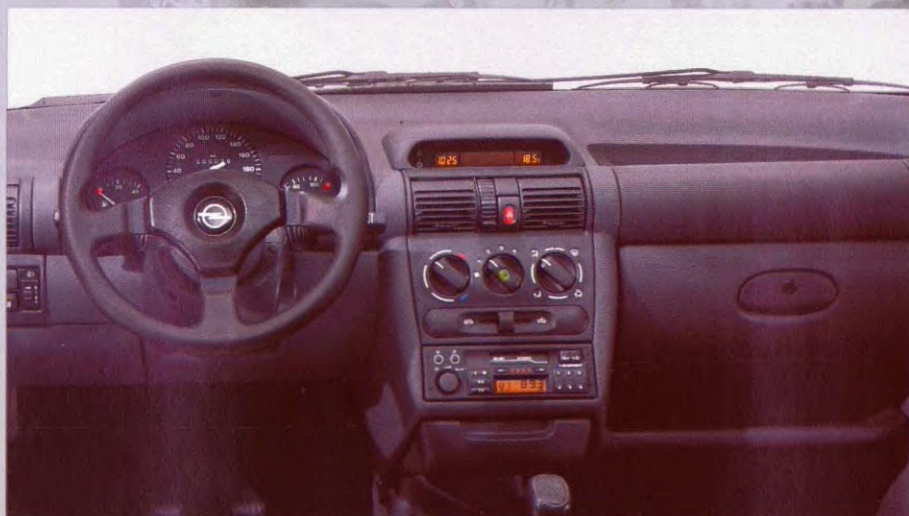
3-spaaks lederen stuurwiel, diameter 36 cm. Bekleed met hoogwaardig leder. Montage met behulp van stootkussen-adapter.
