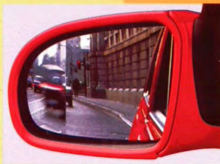
De groothoek-overzet-spiegel aan bestuurderszijde is er zowel elektrisch verstelbaar als met handbediening. Met geslepen spiegelglas en chroom-coating.
