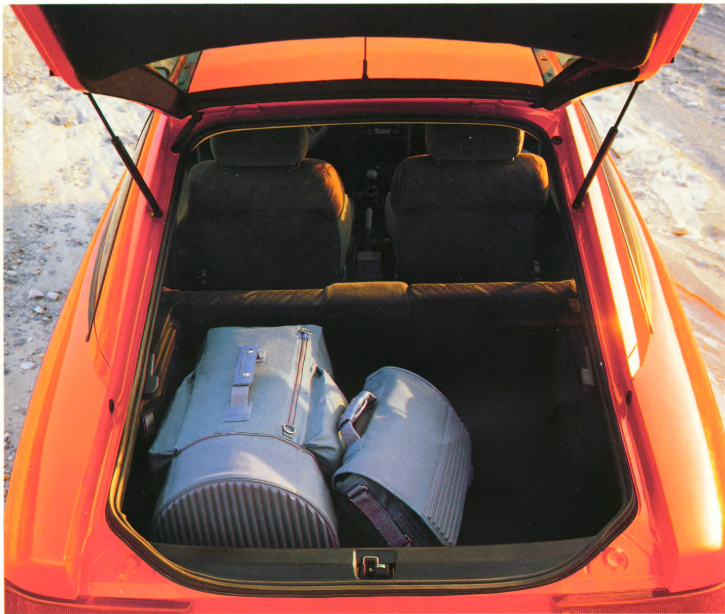
Kofferruimte Calibra: inhoud 300 liter (VDA-meting); met neergeklapte achterbank: 980 liter (VDA-meting).
