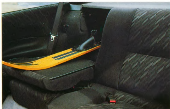
Kofferruimte Calibra: inhoud 300 liter (VDA-meting); met neergeklapte achterbank: 980 liter (VDA-meting).
